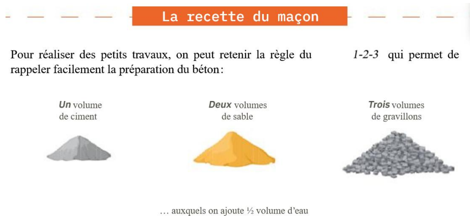
Figure 4. « La recette du maçon ». Pour réaliser des petits travaux, on peut retenir la règle du 1-2-3 qui permet de rappeler facilement la préparation du béton [3]. On obtient tout de même une formulation un peu lourde en ciment, donc onéreuse....
