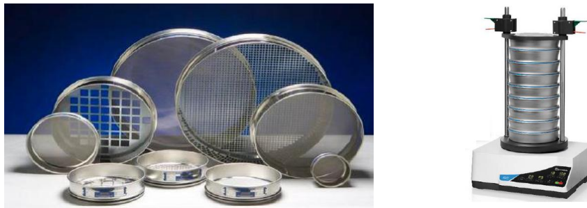
Figure 9. Tamis et colonne de tamis utilisée pour le tamisage mécanique
