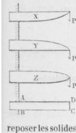
C'est-à-dire que le carré de la hauteur  $h$  sera proportionnel à  $l$ ; et la pièce qui est représentée en plan par le rectangle ABCD (fig. 29), dont la dimension AB =  $b$ , le sera en élévation par l'une quelconque des trois formes paraboliques X, Y, Z, dont le sommet est au point d'application de la force P.
