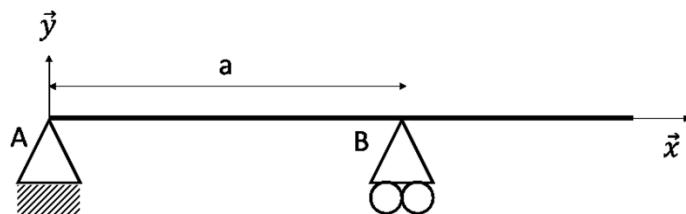
1/ Déterminer les réactions  $Y_A$  et  $Y_B$  aux appuis en A et B en fonction de la  $q$ ,  $L$  et  $a$ .
