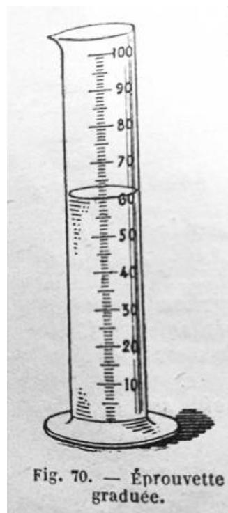
Fig. 70. — Éprouvette graduée.
