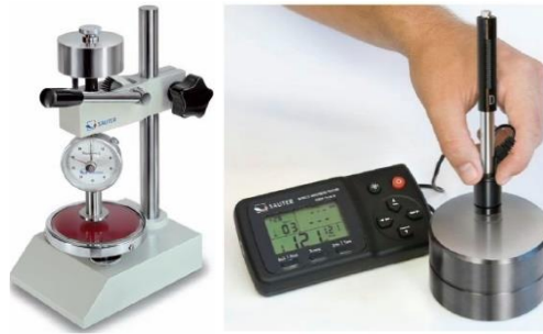
Figure 19. Gauche : Duromètre Shore (SAUTER GmbH). Droite : Dureté Leeb
