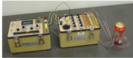
Figure 14. Pont de Wheatstone et instrumentation pour la mesure de déformation ( http://industriel.uqar.ca )
