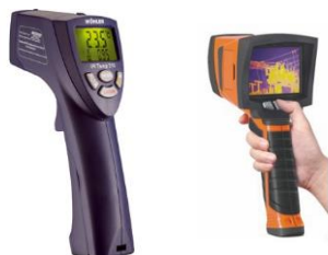
Figure 37. Thermomètre infrarouge et caméra infrarouge ( www.degre5.com )
