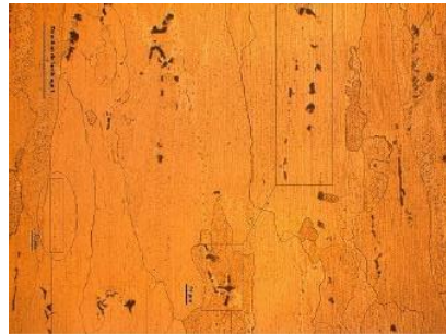
Figure 10. Précipités dans un alliage d'aluminium aéronautique 2024-T351 [3]
