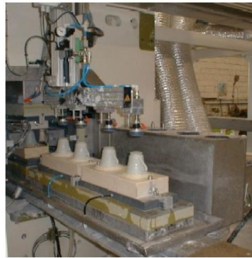
Coulage sous pression de tasses (Photo Elmeceram_Oradour sur Vayres)
