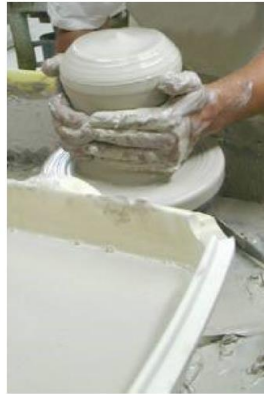
Façonnage d'une porcelaine (Photo Pillivuyt_Mehun sur Yèvre)
